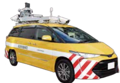
レーザーキャナやカメラを搭載した移動計測車両MMS(モバイルマッピングシステム)。
