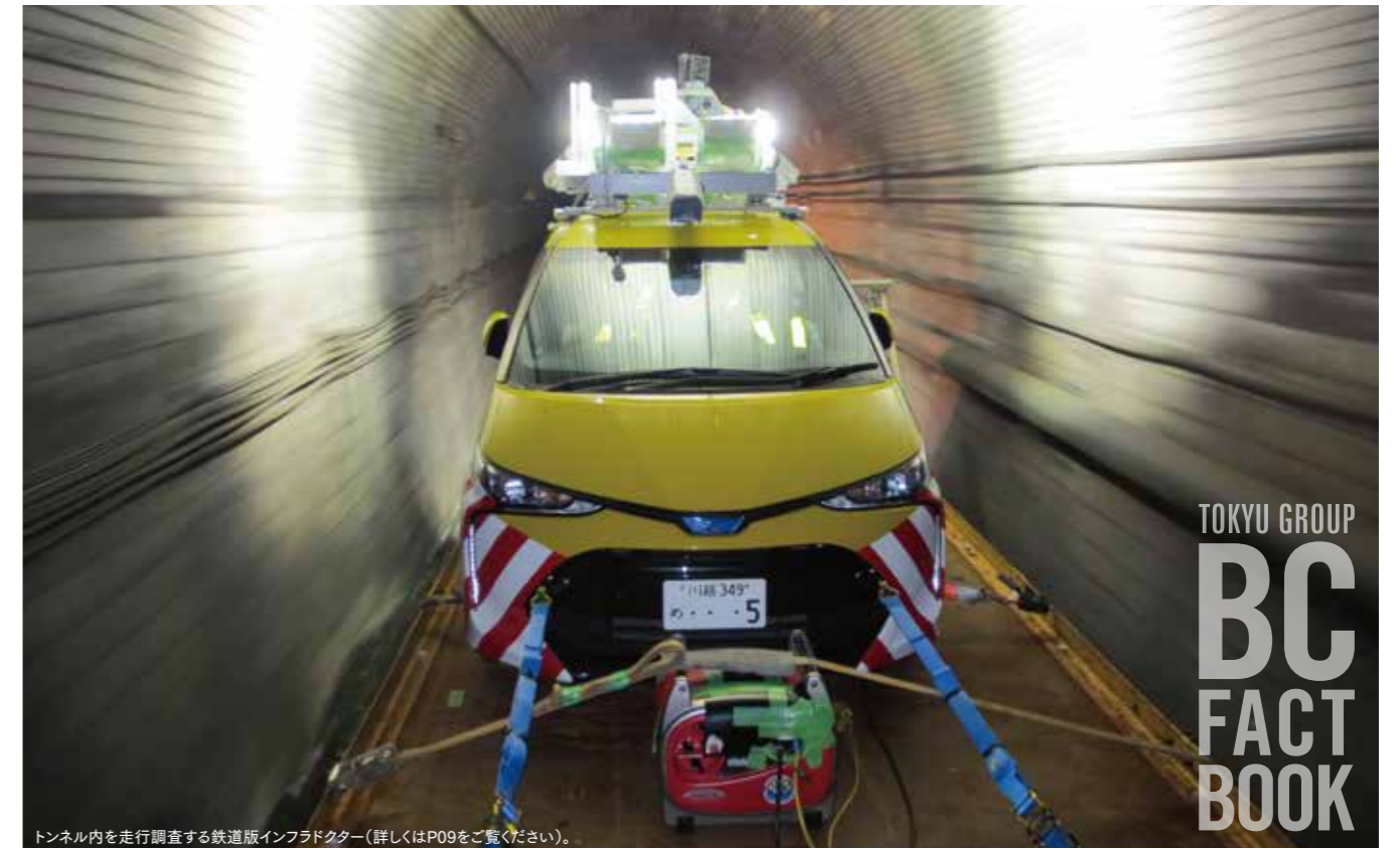
トンネル内を走行調査する鉄道版インフラドクター(詳しくはP09をご覧ください)。
