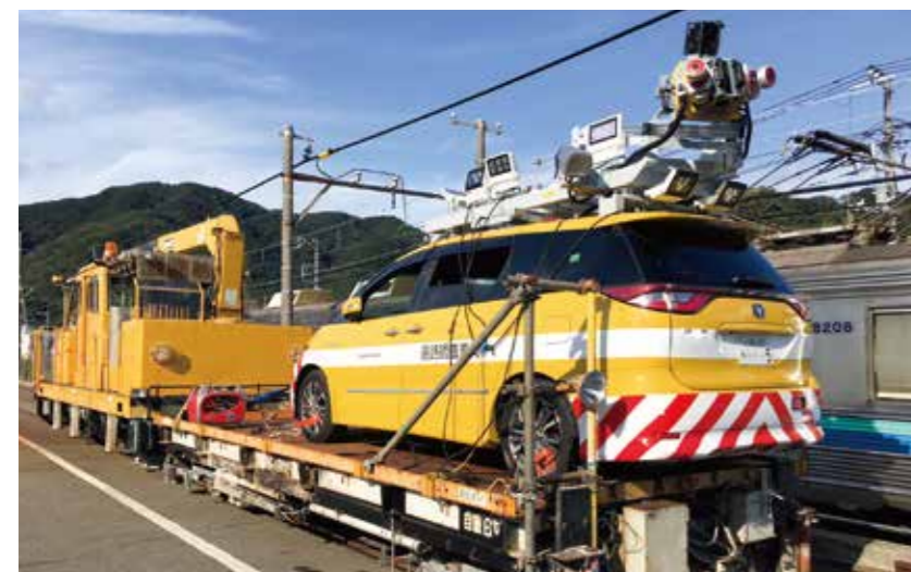
鉄道台車にMMSを積載した鉄道版インフラドクター。
