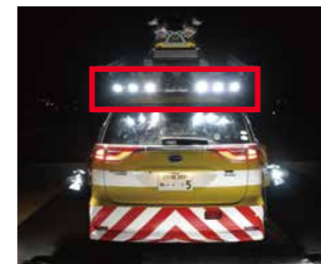
路面性状調査用に高精度のラインセンサカメラを搭載(赤囲み部分)。
