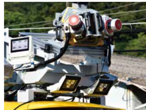
MMSにはレーザーキャナ(100万発/秒×2台)と全方位カメラ(約500万画素×1台)を搭載。
